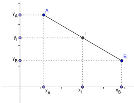
Si  $A(x_A; y_A)$  et  $B(x_B; y_B)$  alors I milieu de [AB] a pour coordonnées  $\left( \frac{x_A + x_B}{2}, \frac{y_A + y_B}{2} \right)$
